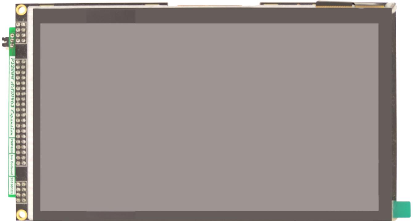
Figura 29: *Espansione P32TFT SD1963 con display.*
