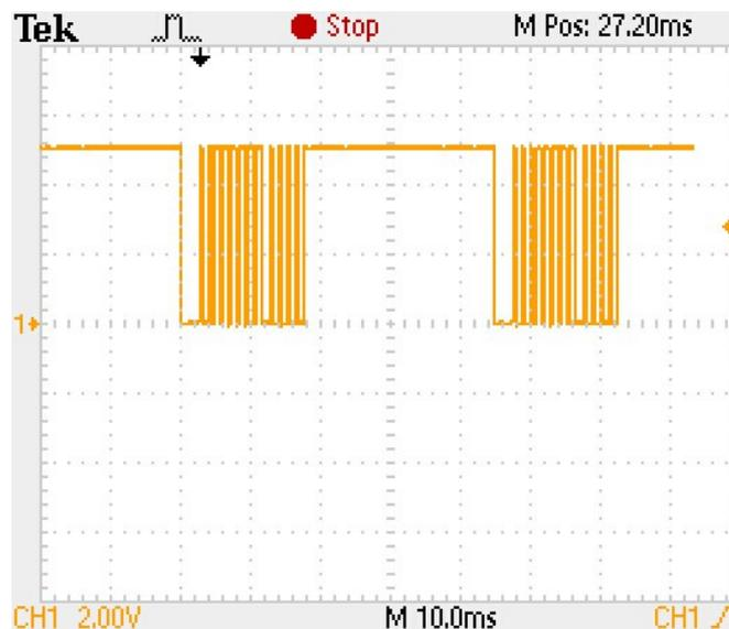
Figura 5: Esempio di ricezione di un treno di impulsi protocollo Sony (SIRC).
