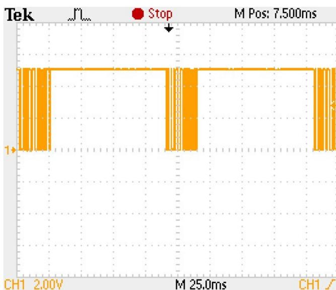
Figura 7: Esempio di ricezione di un treno di impulsi protocollo Philips (RC5).
