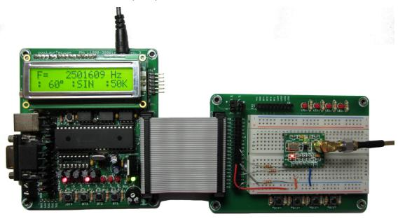
Figura 7: Realizzazione pratica del generatore di segnali.
