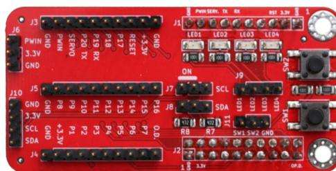
Figura 10: Scheda di espansione mini Sensing - Pin Test Board.
