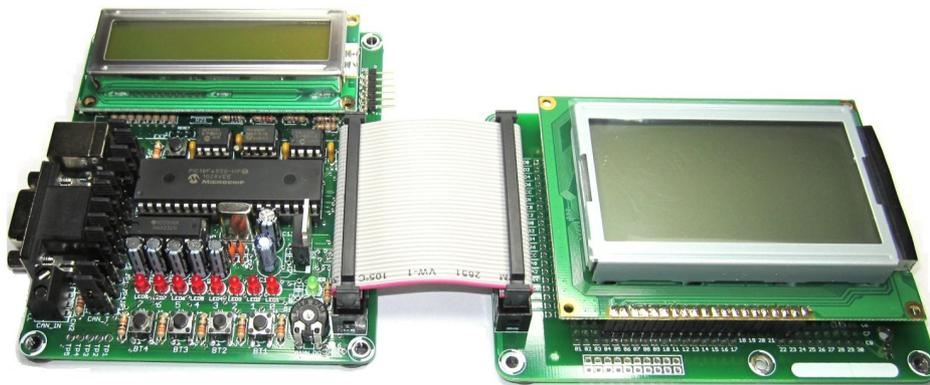
**Figura 28:** Esempio di utilizzo della scheda di espansione con display Grafico GLCD.
