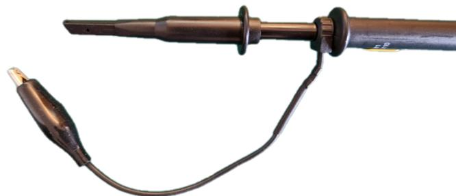
**Figura 6:** Sonda dell'oscilloscopio con collegamento classico di massa (coccodrillo).
