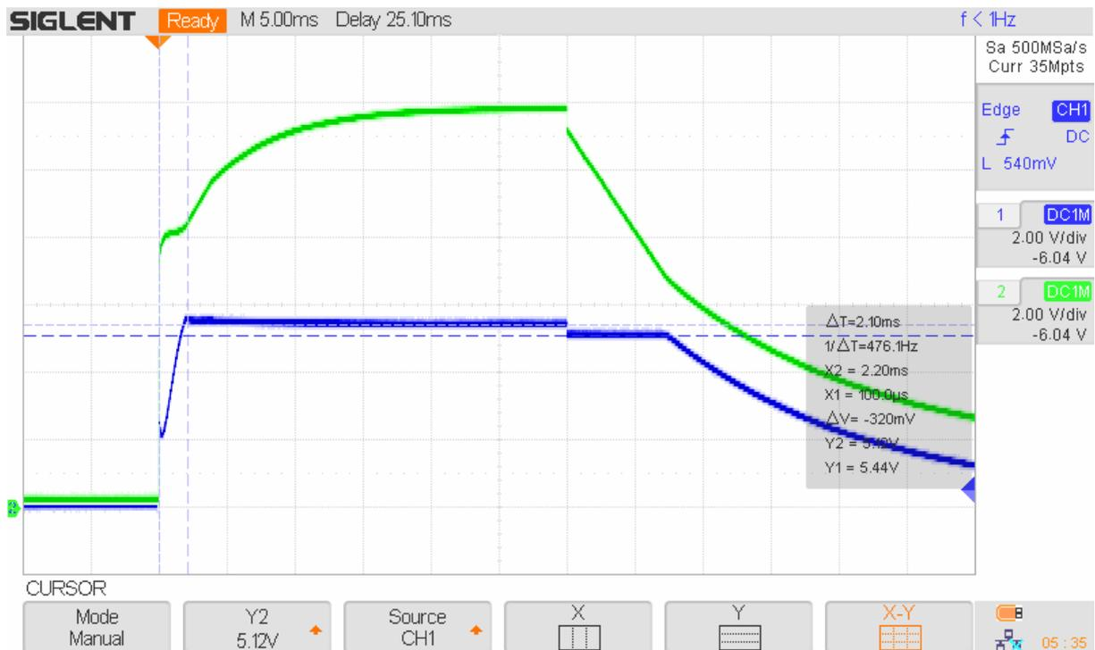
**Figura 8:** Risposta di  $V_{out}$  con carico di  $10\Omega$ , controllo con PMOS – scheda con L7805 ( $V_{in}=12V$   $V_{out}=5V$ ).
