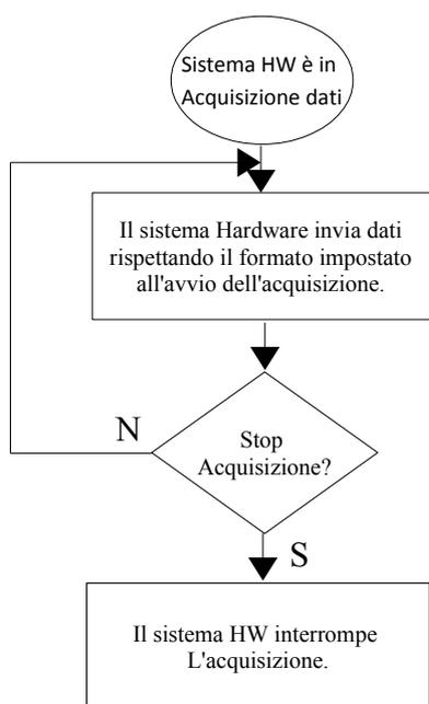
**Figura 4:** Modalità acquisizione continua Data Tracking.
